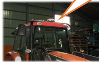
トラクターに取り付けた自動操舵システム
